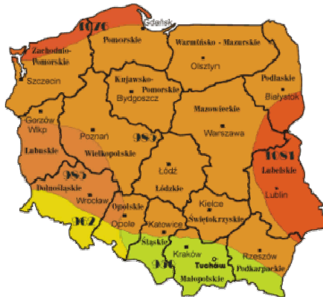
Rys. 2.8. Rejonizacja średniorocznych sum promieniowania słonecznego całkowitego padającego na jednostkę powierzchni poziomej w kWh/m 2 /rok
